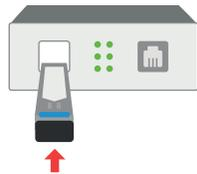
**2** Verbinden Sie die « OTO-Steckdose » mit dem FTTH Media-Converter mittels des Glasfaserkabels.
