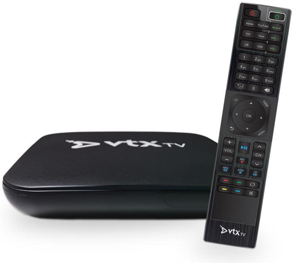
1. Schalten Sie Ihren TV-Decoder aus: Hierzu ziehen Sie sein Stromkabel. Nehmen Sie einen dünnen Gegenstand (z.B. Büroklammer oder Zahnstocher) und drücken Sie damit auf den runden Knopf hinten auf dem Decoder (neben dem Stromkabel).
