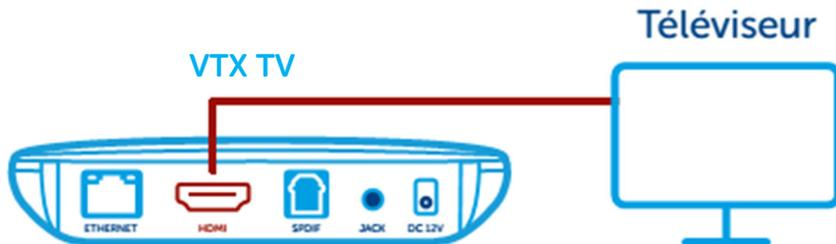
Raccordez une extrémité du câble HDMI à votre décodeur VTX TV et l'autre à votre téléviseur. Si votre téléviseur dispose de plusieurs prises HDMI, configurez-le de manière à sélectionner le port adéquat. Notez que les signaux vidéo et audio sont transmis via le câble HDMI directement au téléviseur. Si votre téléviseur ne possède pas d'entrée HDMI, vous devez vous équiper d'un adaptateur péritel.
