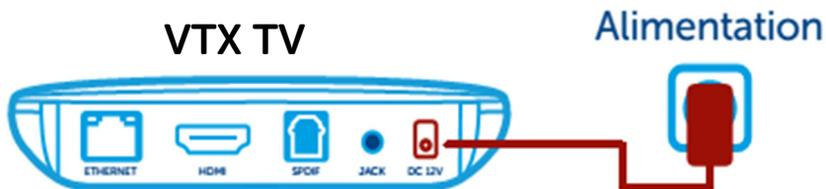
Connectez le cordon d'alimentation dans le décodeur VTX TV, puis le transformateur dans une prise 230V. Le décodeur s'allume de suite.
