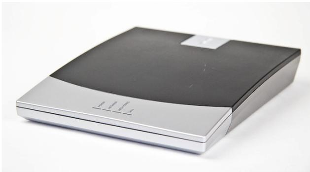
Pour que votre compte SIP s'enregistre, veuillez poser le snom m9 sur le chargeur et appuyer **brèvement** sur le bouton « RESET » de la base (il se trouve à côté de l'entrée du câble d'alimentation - juste **une** pression, sinon vous allez faire un reset total de la configuration !). Laissez la base redémarrer. Lorsque la LED « REGISTERED » s'allume, le compte SIP est enregistré. Vous pouvez désormais recevoir et émettre des appels avec votre snom m9.
