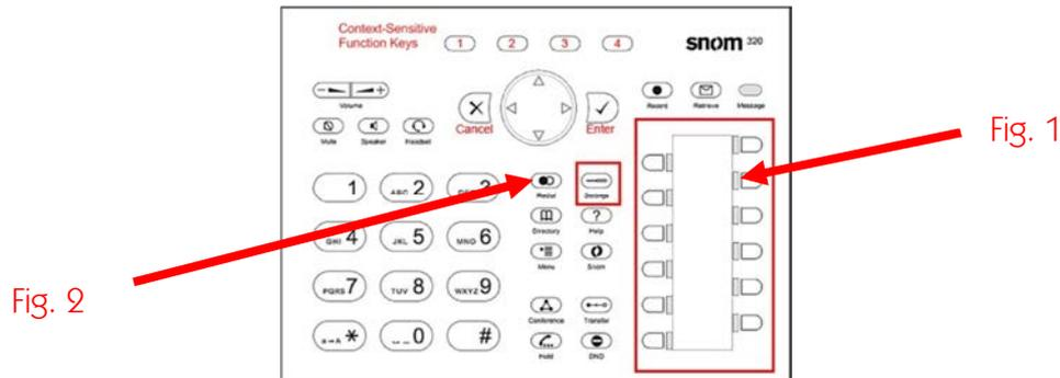
Les touches 1 à 12 sont par défaut configurées en touches de ligne. Il vous est possible de les configurer de façon à ce qu'elle puisse agir de la façon suivante :
