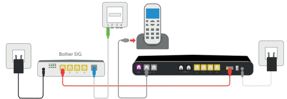
**5** Connectez votre ordinateur à la VTXbox : soit par le câble RJ45 jaune au port LAN 1, soit par la connexion Wi-Fi.
