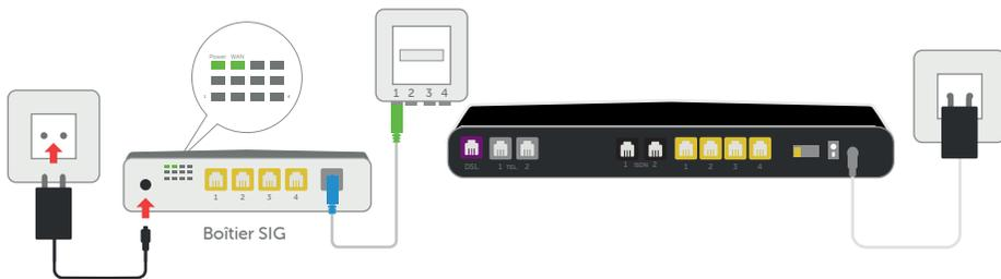
**3** Branchez le câble réseau rouge ou blanc entre le port LAN 1 (entrées) du boîtier SIG et le port de la VTXbox contenant le module SFP.
