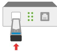
**2** Retirez le capuchon du module fibre puis branchez l'embout vert du câble fibre sur la prise murale fibre (port n° 2) et l'embout bleu sur le module fibre.
